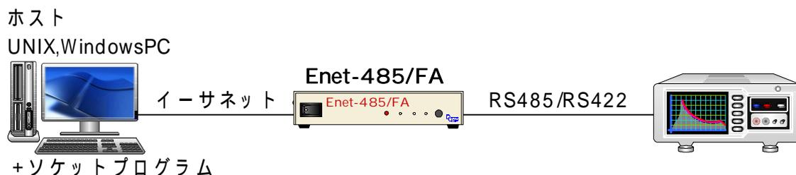
Enet-485/FAには自機IP/PORTの設定 (IP=, PORT=) 及びホストマシンのIP/PORT (nnl=, nnP=) の設定が必要です。
