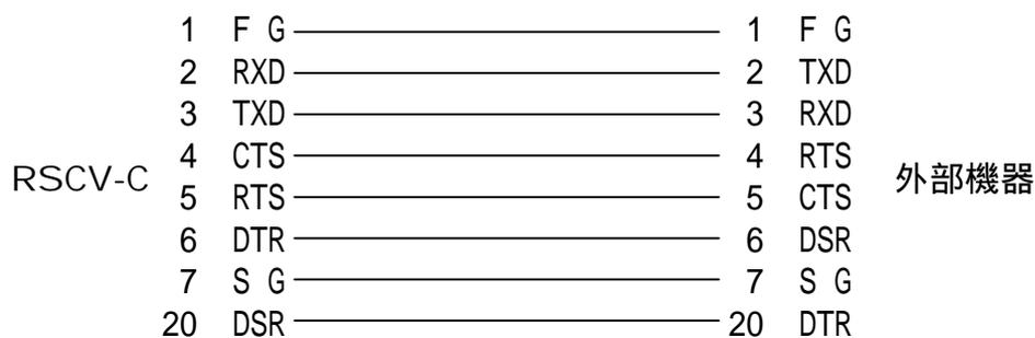
**ご注意** Dsub25 ピンメス DTE 配列の RS232C ポートを持つ機器は、[RSCV-C] を直結して使用します。ケーブルを介して接続する場合は、(1)と同様の注意が必要です。
