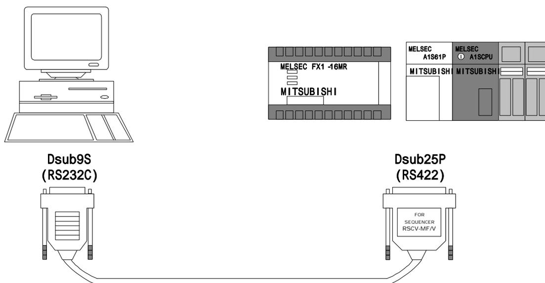
Dsub25ピンコネクタをシーケンサに、Dsub9ピンコネクタをDOS/Vパソコンに接続します。
