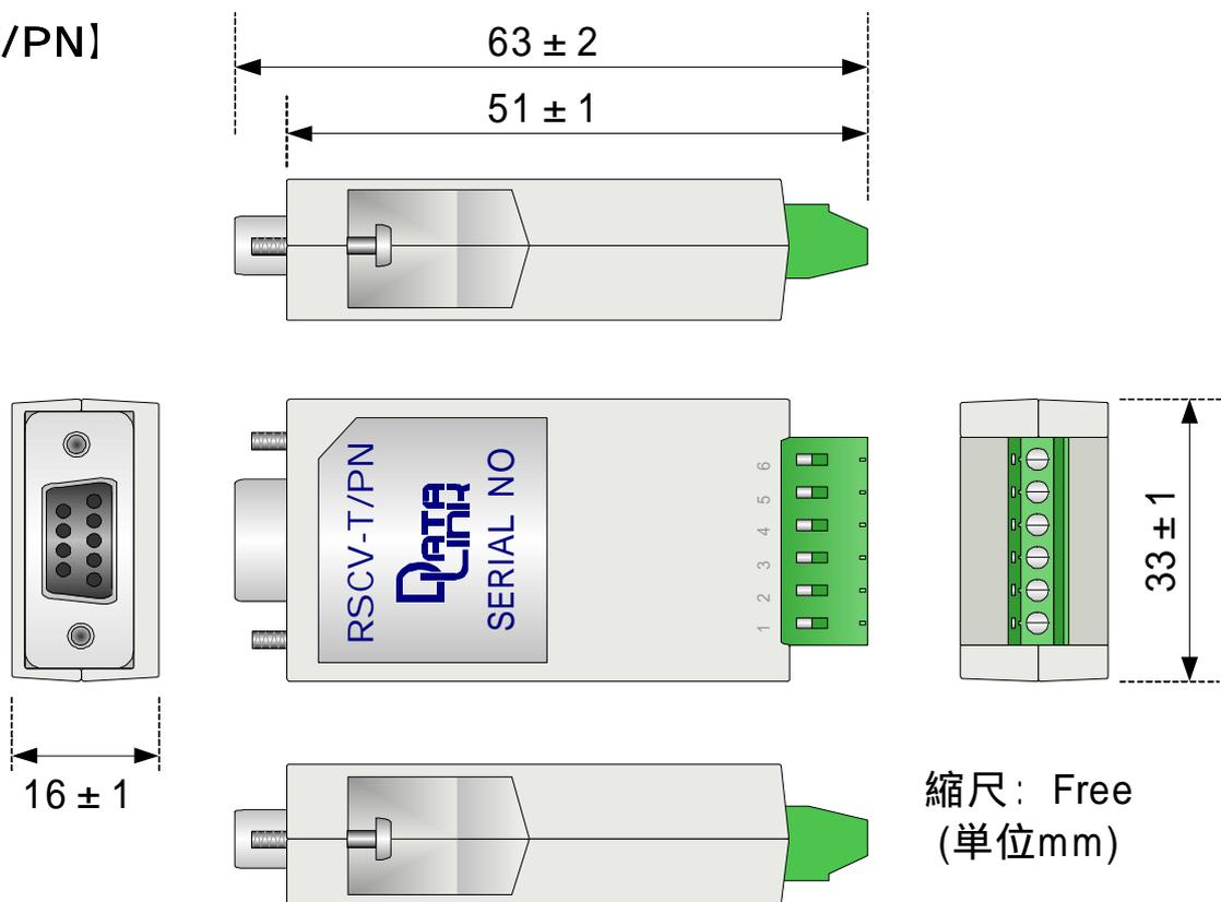
RS232C コネクタ : Dsub9Pメス 取付ネジ : #4-40 × 13 UNC インチネジ
