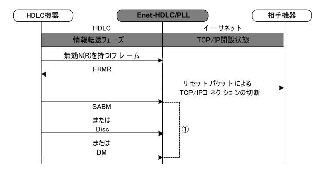
TCP/IPコネクションを切断後の動作は相手HDLC機器からの応答により異なります。
