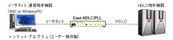
**Enet-HDLC/PLL** には 自機 IP/PORT の設定 (IP=,PORT=) 及びホストマシンの IP/ PORT(nnI=, nnP=) の設定が必要です。
