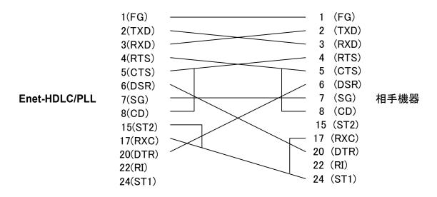
※ Enet-HDLC/PLL プログラムモード設定 TCLK=2 選択の場合 送信クロック 及び受信クロック のどちらともに相手機器の 24 (ST1)となります。相手機器の 15 (ST2) の処理に関しては接続機器の仕様をご確認下さい。
