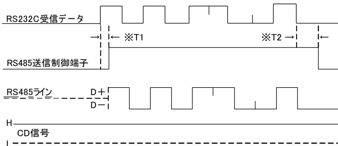
※ T1: RS232Cのスタートビットを検出して、RS485が送信可能状態になるまでの遅延時間、標準品、低速版ともに:  $3 \mu\text{sec}$
