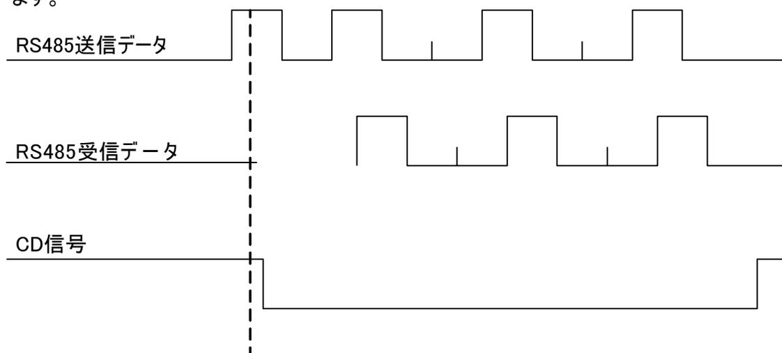
※ **CD485-RoHS**は、データの衝突による負荷でトランシーバの破損を防ぐサーマルシャットダウン回路が内蔵されています。
