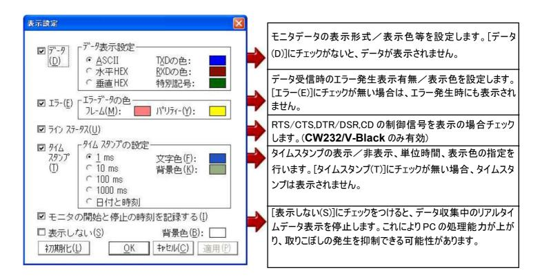
③ モニタ開始ボタン を押します。以降 RS232C,RS422/485 上に流れるデータがモニタされます。 PC のメモリ上に、モニタデータを保存します。保存可能領域は、PC の画像解像度等に依存しますが、約 2048Line 分の保存が可能です。これを越えるデータを受信の場合は、順次上書きされます。
