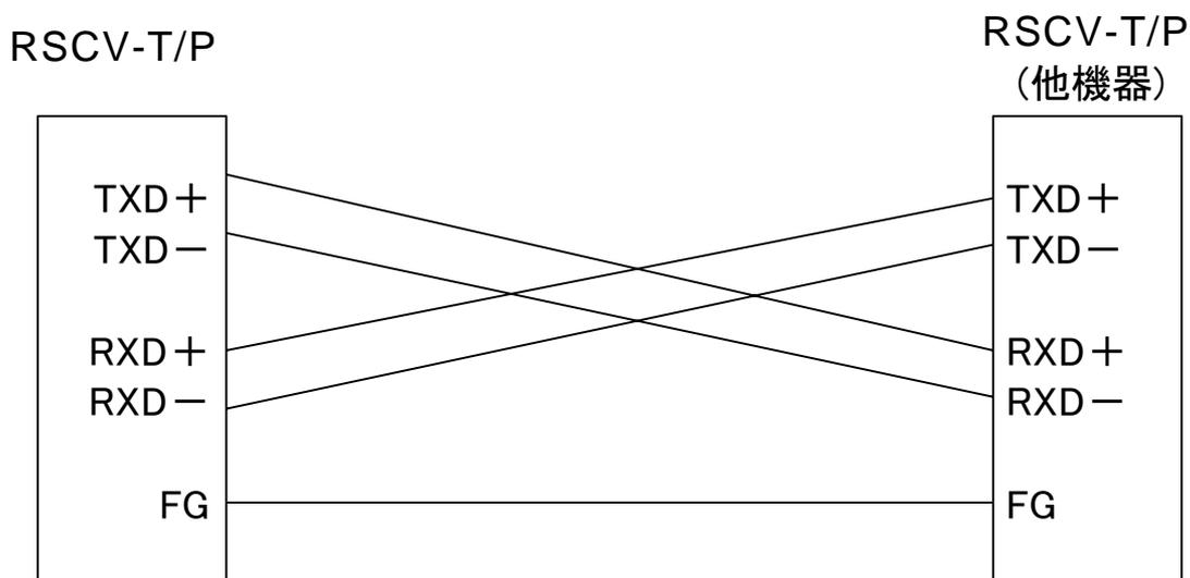
ご注意5番のFGは、DC/DCコンバータの出力絶縁グランドです。RS422接続機器のアース接地状態、GNDレベルの電位差等を考慮に入れ、システムの状態に応じて結線あるいは断線してください。
